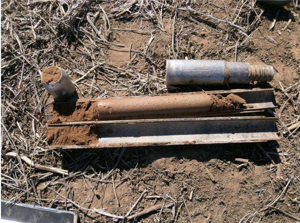
**Foto 9 – Muestras del sondeo S5 a 6 m de profundidad**
