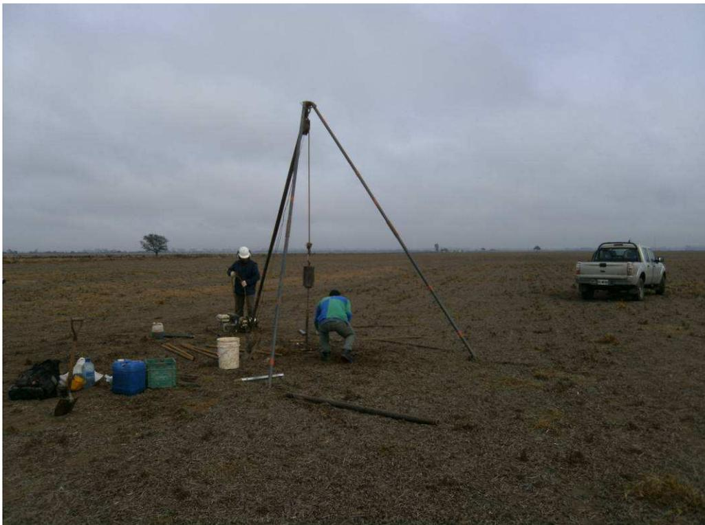
**Foto 6 – Ejecución de ensayo SPT en sondeo S1**
